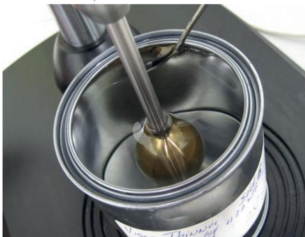
La flessibilità del prodotto permette all'utente il massimo controllo durante il processo di riduzione della viscosità fornendo inoltre analisi di stabilità molto utili. Si addice quindi ad attività di laboratorio e produttive.
